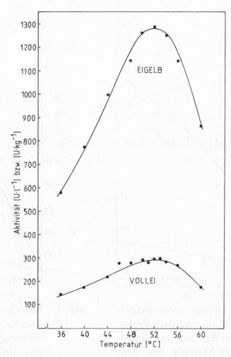
Abb. 1. Temperaturoptimum der Alpha-Amylase in Vollei [U\*l-1] und Eigelb [U\*kg-1] nach Bestimmung mit dem Phadebas<sup>R</sup>-Amylase-Test
