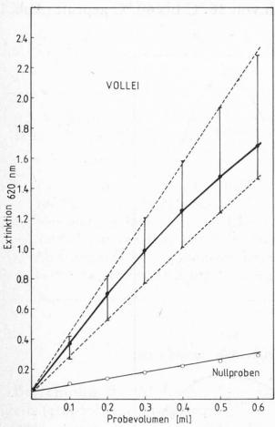
Abb. 2. Beziehung zwischen der Extinktion bei 620 nm und dem Probevolumen bei Bestimmung der Alpha-Amylase-Aktivität mit dem Phadebas<sup>R</sup>-Amylase-Test bei 5 unterschiedlichen Volleiproben
