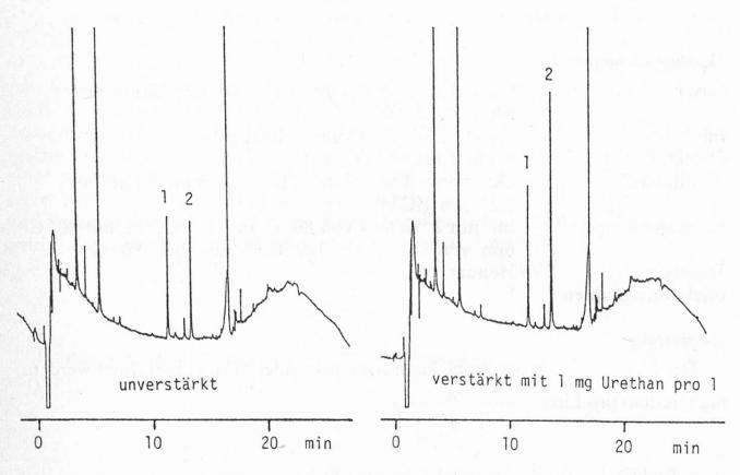
Abb. 1. Gaschromatogramm eines Kirschextraktes. 1 = Methylcarbamat 2 = Urethan
