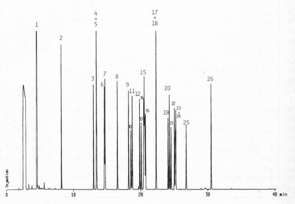
Fig. 1. Séparation des produits de dégradation thermique et de thermooxydation sur CP-Sil 5 (conditions: voir tableau 3)
