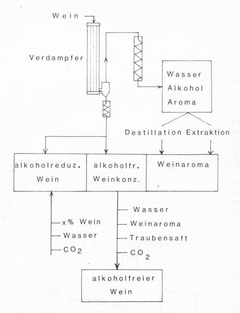
Abb. 6. Fliessbild für die Herstellung von alkoholreduziertem bzw. alkoholfreiem Wein
