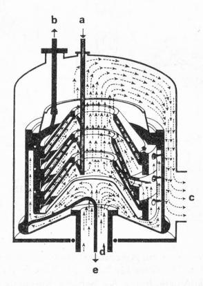
Abb. 3. Zentrifugalverdampfer Typ Centri-Therm der Firma Alfa-Laval a = Produkteintritt, b = Konzentrataustritt, c = Brüdenaustritt zum Kondensator, d = Heizdampfeintritt, e = Heizdampfkondensataustritt
