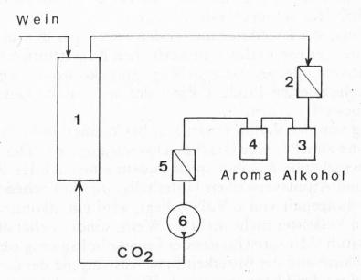
Abb. 10. Schematische Darstellung der Entalkoholisierung von Wein durch Hochdruckextraktion mit CO<sub>2</sub>
