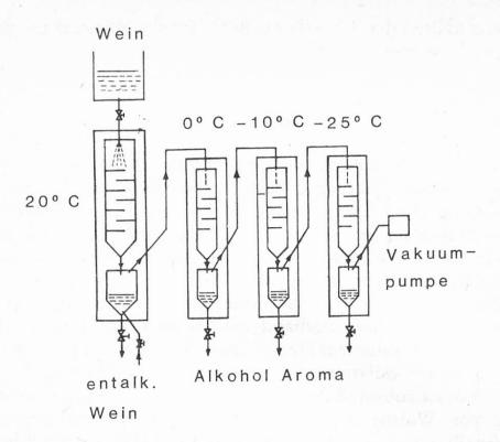
Abb. 2. Entalkoholisierung von Wein durch Partialkondensation nach Déglon (9), Schweizer Patent 564603
