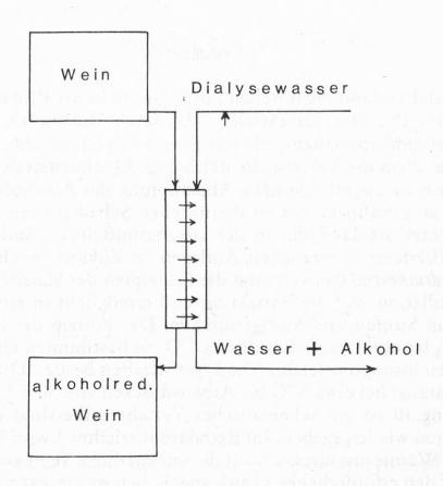
Abb. 8. Schematische Darstellung der Entalkoholisierung von Wein durch Dialyse
