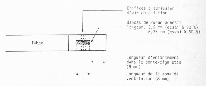
Fig. 4. Simulation de l'obturation latérale
