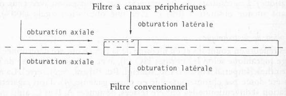
Fig. 3. Modes d'obturation du dispositif de ventilation
