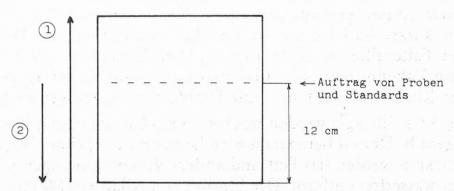
Abb. 1. Auftrags- und Entwicklungsschema für die Dünnschichtchromatographie
