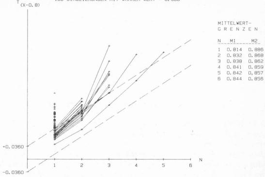
Abb. 2. Monte-Carlo-Simulationen eines einseitigen Folgetestes
