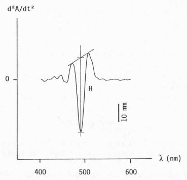
Fig. 1. Spectre en mode «dérivée seconde» d'une solution de 200 ng de fluorescéine dans 3 ml de mélange méthanol-ammoniaque 95 : 5 et illustration du mode de mesure de la hauteur du pic (Conditions expérimentales: spectrophotomètre Kontron AG «UVIKON 810», spectre de 600 á 400 nm à 100 nm/min, largeur de dérivation 4,0 nm, constante de temps 8,0 secondes, échelle de l'enregistreur 0,1%)
