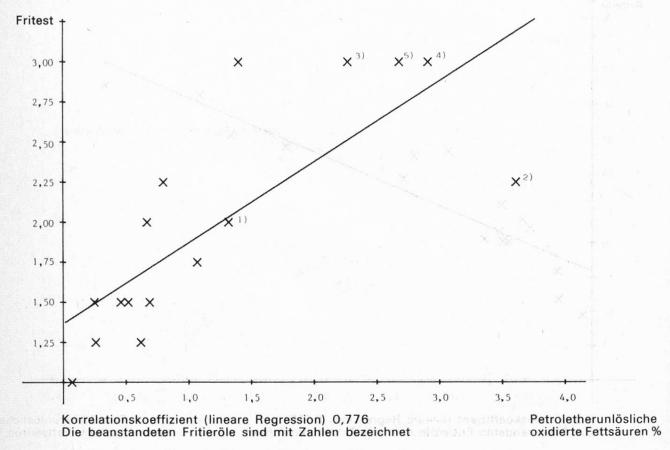
Abb. 26. Korrelation: Petroletherunlösliche oxidierte Fettsäuren / Fritest
