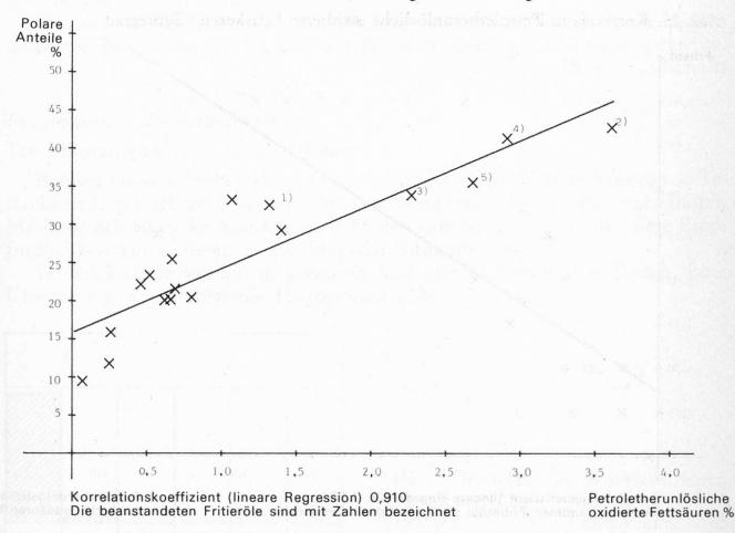
Abb. 24. Korrelation: Petroletherunlösliche oxidierte Fettsäuren / Polare Anteile
