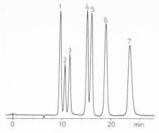
Abb. 1. Trennung einer Säuremischung an einem Kationentauscher
