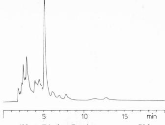
Abb. 6. Direkte Bestimmung von Chlorogensäure in Apfelsaft
