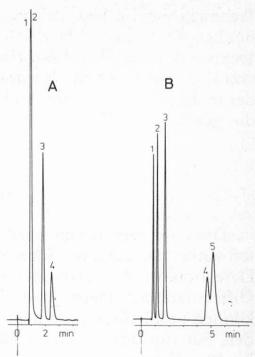
Abb. 8. Ionenpaarchromatographie. fluß des pH's auf die Trennung Kolonne: Lichrosorb RP 18, 10 μm Partikel, 250 x 3 mm Mobile Phase: 70% wässerige 0,05 m Phosphorsäure 30% Methanol 0,005 m Hexylamine pH der mobilen Phase: A = 7,0B = 2.5Flußrate: 1,0 ml/min Peaks: Chromatogramm A: 1 = Gallussäure + Protocatechusäure 2 = para-Hydroxybenzoesäure
