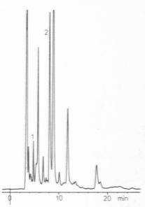
Abb. 4. Direkte Bestimmung organischer Säuren im Tomatensaft
