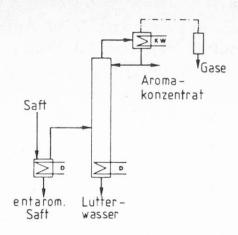
Abb. 1. Aromagewinnungsanlage mit Abtrennung der Aromastoffe durch Verdampfen D = Dampf, KW = Kühlwasser
