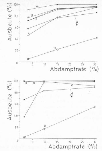
Abb. 8. Aromastoffausbeuten diverser Komponenten bei der konventionellen Entaromatisierung (oben) und beim Dampfstrippen (unten) von Birnensaft
