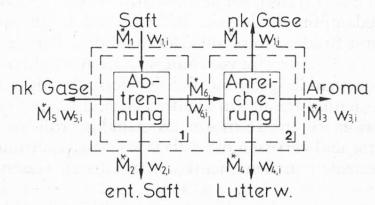
Abb. 2. Schematische Darstellung der Massenströme einer Aromaanlage mit den Bilanzgebieten 1 und 2
