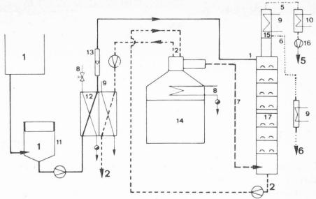
Abb. 3. Versuchsanlage zum Dampfstrippen von Fruchtsäften
