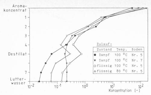
Abb. 7. Durchschnittlicher Verlauf der Aromakonzentrationen bei der Anreicherung in dimensionsloser Darstellung, Durchschnittswerte wie Abbildung 4
