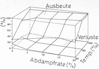
Abb. 5. Aromaausbeute im Destillat und Verluste im entaromatisierten Saft beim Dampfstrippen von Apfelsaft. Aromastoffe wie Abbildung 4
