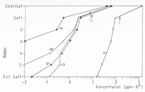
Abb. 6. Konzentrationsverlauf mehrerer Komponenten beim Dampfstrippen von Apfelsaft bei einer Abdampfrate von 12%
