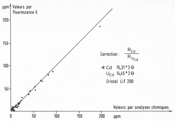
Fig. 3. Cadmium. Comparaison des valeurs obtenues par fluorescence de rayons X et par analyses chimiques
