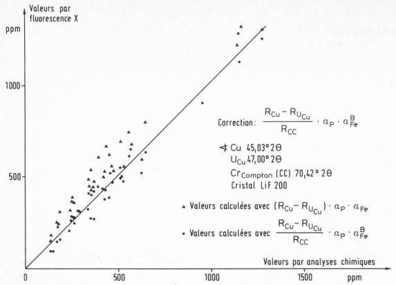
Fig. 5. Cuivre. Comparaison des valeurs obtenues par fluorescence de rayons X et par analyses chimiques R, U,  $\alpha_B$ , voir figures 3 et 4;  $\alpha$  = alpha théorique,  $R_{CC}$  = nombre d'impulsions par seconde sur la raie Compton du chrome
