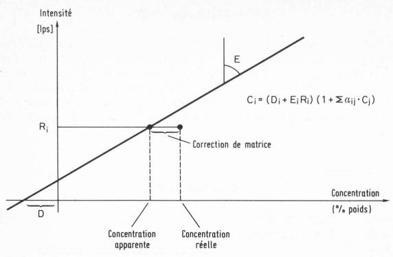
Fig. 2. Droite d'étalonnage
