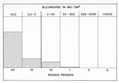
Abb. 3. Resultatübersicht der Proben, die auf Bleiabgabe des Lippenrandes von Trinkgefäßen (2 cm breiter äußerer Rand) geprüft wurden Grenzwert 3 mg/dm<sup>2</sup>
