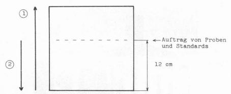
Abb. 2. Auftrags- und Entwicklungsschema für die Dünnschichtchromatographie
