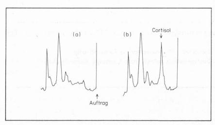
Abb. 10. Fluoreszenzortskurve von Cortisol-Dansylhydrazon nach Fertigsäulen-Extraktion
