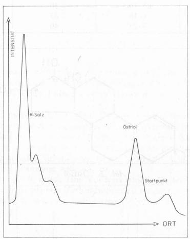
Abb. 4. Remissionskurve Östriol-Fast-Dark-Blue-R-Salz Sorbens: HPTLC-KG-60; Fließmittel: Chloroform/Aceton (15/5); λ = 520 nm
