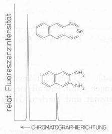
Abb. 16. Fluoreszenzortskurve von 2.1.3-Naphthoselenodiazol und 2.3-Diaminonaphthalin Sorbens: HPTLC-KG-60; Fließmittel Toluol;  $\lambda_A=365$  nm;  $\lambda_F>560$  nm
