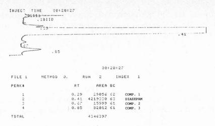
Abb. 4. Trennung der Spurenkomponenten in Diazepam
