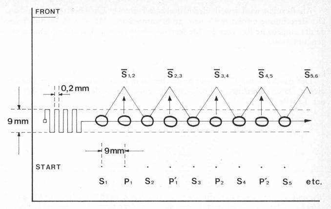
Abb. 2. Laterale Messung, quer zur Laufrichtung  $S_1-S_9 = Standards$  entsprechend 100% der Deklaration  $P_1$ ,  $P_1$ ' etc. = Proben, jeweils zweimal aufgetragen
