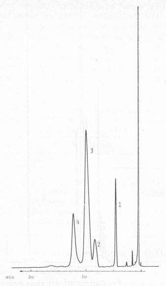
Abb. 3. Gaschromatogramm desselben Gemisches wie in Abbildung 2 3m DEGS 10% i. d., 2 mm, 1,8 atm He, 180 °C isotherm. 1 = C16:0 2 = C18:0 3 = C18:1 4 = C18:2
