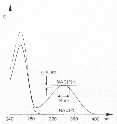
Abb. 3. Absorptionsspektrum von NAD(P) und NAD(P)H
