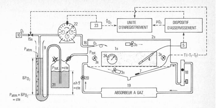
Fig. 4. Détail de l'analyseur proposé pour les macromesures (variante B) Conditions de travail:
