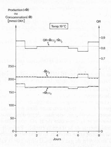
Fig. 10. Détermination des débits massiques du gaz carbonique produit  $(+M_{CO_2})$  et de l'oxygène consommé  $(-M_{O_2})$  ainsi que du quotient respiratoire QR d'un fromage de Gruyère âgé de 6 semaines lors d'un encavage de 8 jours consécutifs à 19 °C
