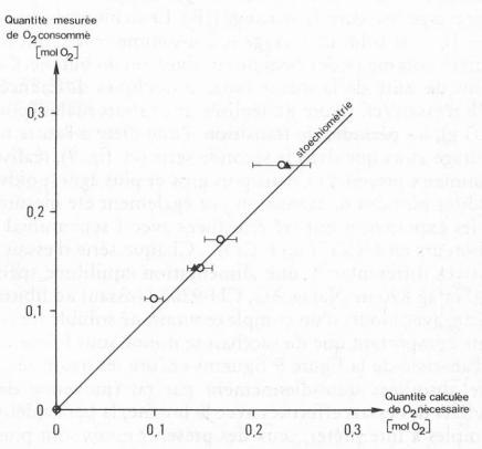
Fig. 7. Vérification expérimentale du fonctionnement du dispositif proposé (variante A pour semi-micromesures) en utilisant l'oxydation enzymatique de l'éthanol en acide acétique comme réaction stoechiométrique modèle
