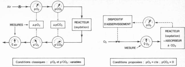
Fig. 1. Schéma de principe simplifié du dispositif déjà décrit et utilisé pour mesurer la consommation d'oxygène et la production de gaz carbonique lors de réactions d'oxydation telles que combustions et respirations rapides
