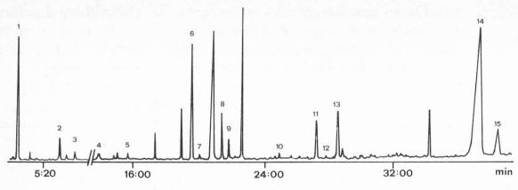
Abb. 2. Gaschromatogramm der Autolyseprodukte von schonend entfettetem Raps (Sorte «Garant»)\*.
