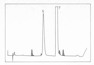
Figure 2. Chromatogramme de l'extrait éthéré d'un yoghourt «vanille» aromatisé avec un mélange de vanilline et de parahydroxybenzaldéhyde synthétiques. Les pics hachurés sont dûs au yoghourt ou à une contamination. Le rapport V/P = 20,8
