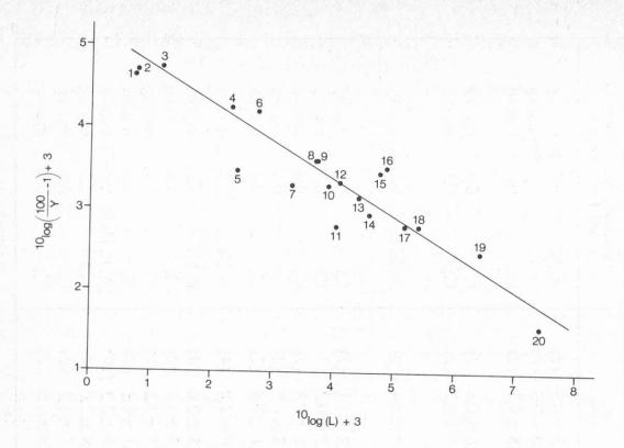
Abb. 1. Abhängigkeit der Übergangsverhältnisse (Y) verschiedener Pestizide von ihrer Wasserlöslichkeit bei Zimmertemperatur (L) – (Code vgl. Tabelle 5, Regressionsgerade vgl. Beziehung IV)
