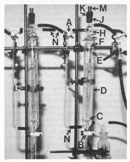
Fig. 3. Vue de 2 barboteurs analytiques en fonctionnement dans une batterie, avec détail de l'un d'eux.
