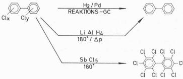
Abb. 1. Chemische Umwandlung der PCB-Verbindungen zu einheitlichen Stoffen
