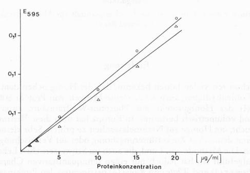
Abb. 1. Standardkurve mit Bradford/Bio-Rad-Reagenz. Extinktion (E)<sub>595</sub> bei 595 nm, gemessen bei verschiedenen Proteinkonzentrationen (Gammaglobulin). Blindwert abgezogen
