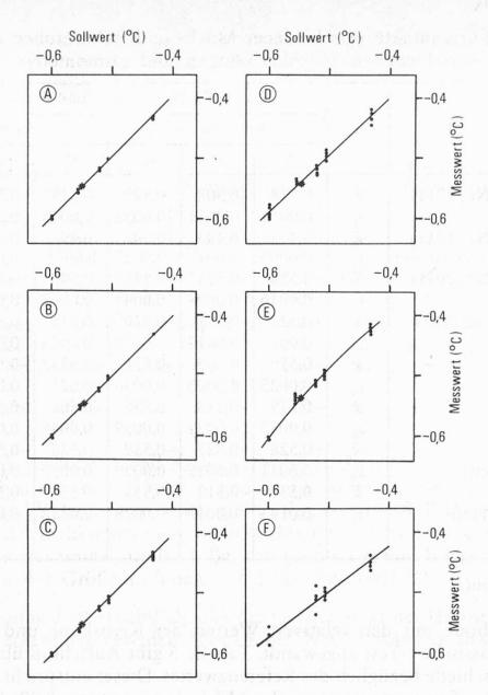
Abb. 2. Eichkurven der Milchkryoskope (A, B, C) und Osmometer (D, E, F) im Temperaturbereich von -0,4 °C bis -0,6 °C.
