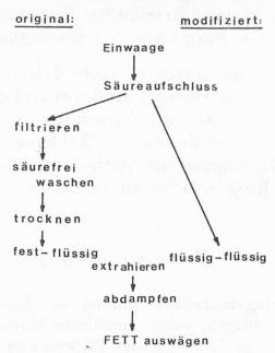
Abb. 1. Verfahrensschema der Fettbestimmungsmethode
