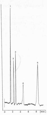
Abb. 2. Chromatogramm einer Aminmischung mit der mobilen Phase b) Acetonitril/ Phosphatpuffer 30/70 <sup>v</sup>/<sub>v</sub>
