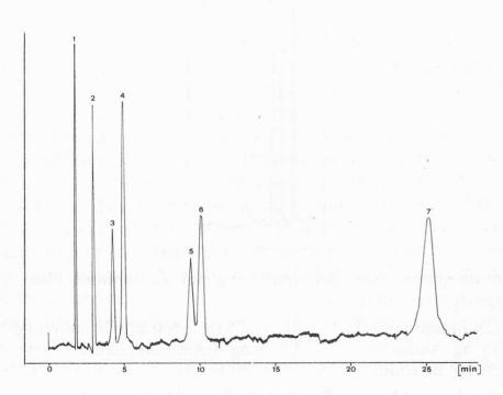
Abb. 1. Chromatogramm einer Aminmischung mit der mobilen Phase a) Acetonitril/ Phosphatpuffer 20/80 <sup>v</sup>/<sub>v</sub>
