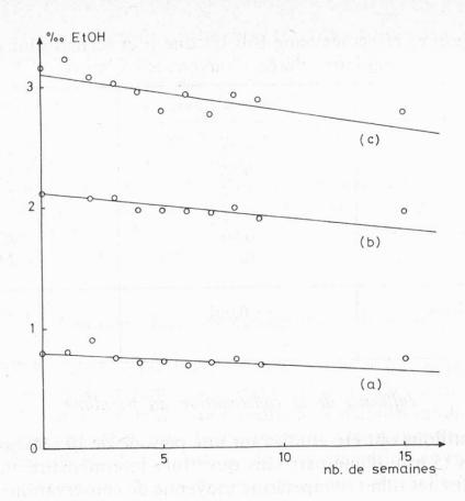
Fig. 5. Evolution de la teneur en éthanol de 3 échantillons conservés au frigidaire (5 °C).
