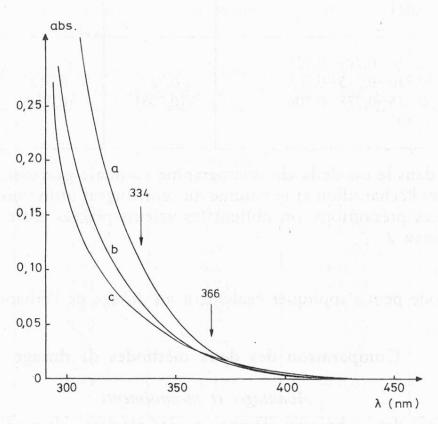
Fig. 4. Spectre d'absorption de divers blancs a = blanc avec tungstate conservé 10 jours b = blanc avec tungstate fraîchement préparé c = blanc avec HClO<sub>4</sub>
