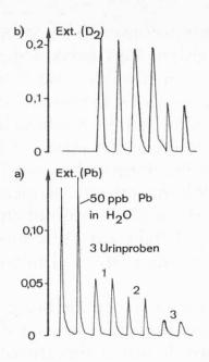
Abb. 5. Absorptionssignale einer wässerigen Standardlösung mit 50 ppb Pb und der 3 Urinproben Nr. 1-3 aus Abb. 1 (33, 17 und 10 ppb Blei) nach der Zugabe von 25 μl 20%iger Phosphorsäure zu 250 μl unverdünnter Probe (Graphitrohr mit Ammoniummolybdat imprägniert)
