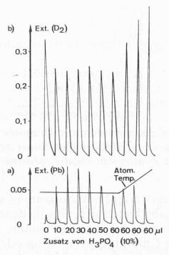
Abb. 3. Verminderung der Empfindlichkeitsunterdrückung und der unspezifischen Absorption durch NaCl und KCl bei Zugabe von 0 bis 60 μl 10%iger Phosphorsäure zu 250 μl unverdünntem Urin (Nr. 1, Abb. 1) (Graphitrohr mit Ammoniummolybdat imprägniert)
