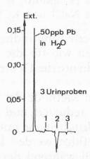
Abb. 1. Absorptionssignale einer wässerigen Standardlösung mit 50 ppb Pb und 3 unverdünnten Urinproben Nr. 1–3 mit 33, 17 und 10 ppb Blei
