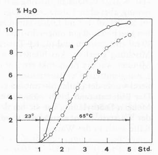
Abb. 3. Verhalten von Fructose bei der KF-Titration in Methanol mit und ohne Zusatz von Diäthylamin
