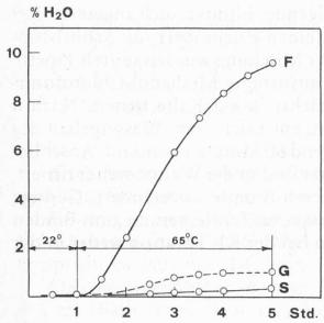
Abb. 2. Verhalten verschiedener Zukkerarten bei der KF-Titration in Methanol 1 Stunde bei 22 °C titriert, anschließend bei 65 °C
