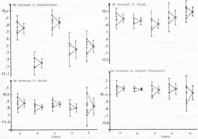
Abb. 3. Graphische Auswertung des Ringversuches
