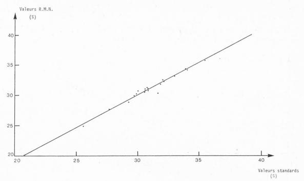
Fig. 2. Détermination de graisse dans les chocolats Comparaison entre méthode standard et méthode RMN (facteur de correction F = 2,60)
