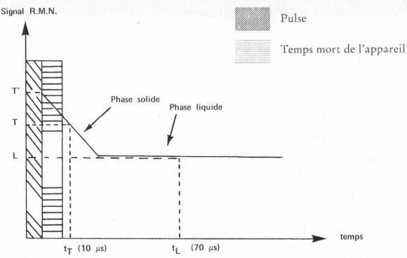
Fig. 1. Schéma de relaxation d'un échantillon contenant une fraction liquide et une fraction solide
