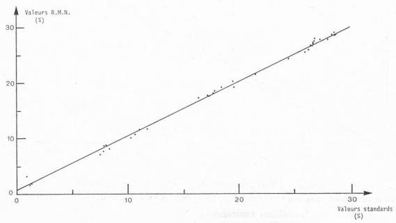
Fig. 4. Détermination de graisse dans les poudres de lait et farines lactées non déshydrates Comparaison entre méthode standard et méthode RMN (facteur de correction F = 2,40)
