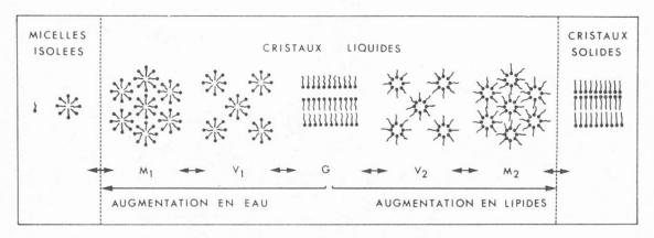
Fig. 2. Variation des micelles en fonction de la teneur en eau du milieu
