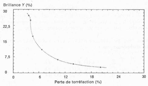
Fig. 1. Effet de la torréfaction sur la couleur
