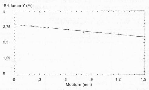
Fig. 3. Effet de la mouture sur la brillance à torréfaction donnée
