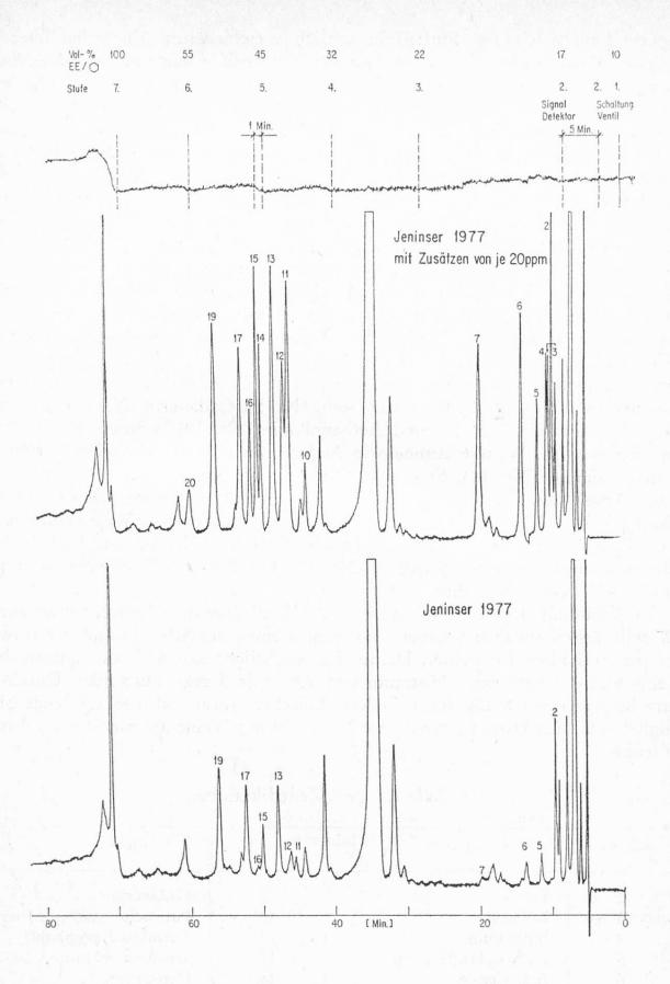
Abb. 2. Oben: Arbeitsweise des Stufengradienten EE = Essigsäureäthylester Mitte: DANS-amide eines Ostschweizer Rotweines mit Zusätzen von je 20 ppm Unten: DANS-amide eines Ostschweizer Rotweines
