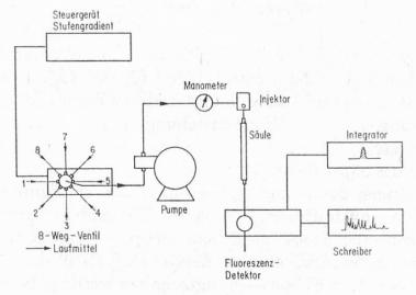
Abb. 1. Modular aufgebaute Apparatur eines Flüssigchromatographen mit Stufengradient
