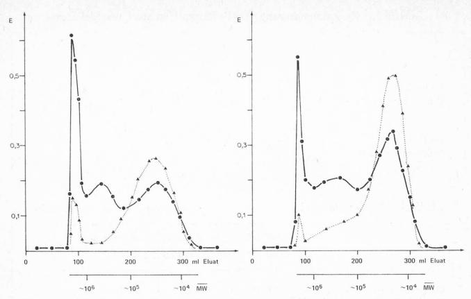
Abb. 1. Fraktionierung löslicher Ballaststoffe aus Kartoffeln (links) und Karotten (rechts) an Sepharose 6B (Säule 2,6 x 60 cm). Extinktionen (E) der Totalzucker bei 485 nm (Phenol-H<sub>2</sub>SO<sub>4</sub>) und der Uronsäuren bei 530 nm (Carbazoltest) ... Molekulargewichte (MW) geschätzt nach Kalibrierung der Säule mit Eich-Dextranen (Pharmacia).
