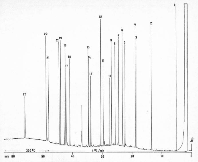
Fig. 2. Chromatogramme capillaire des HAP par injection «on-column», sur une colonne SE-52, 25 m, φ int. = 0,25 mm. Programmation de température: 100°C, 4°C/min, isotherme 300°C
