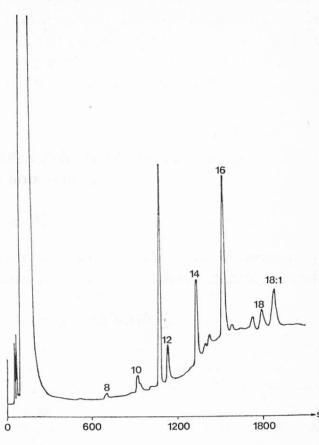
Abb. 5. Chromatogramm der Ethylester der freien Fettsäuren in Rahmfett nach BDI
