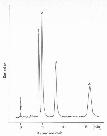
Abb. 4. LC der Fluramderivate aromatischer Amine LiChrosorb RP-18. Elutionsmittel 55% 0,1 m Boratpuffer pH 8,0, 45% Methanol. Fließgeschwindigkeit 0,8 ml/min. Anregungslicht 399 nm, analysiertes Licht 500 nm
