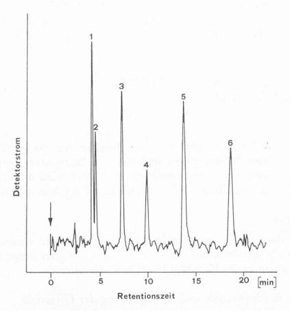
Abb. 2. LCEC einer Mischung aromatischer Amine Nucleosil C-18. Elutionsmittel 30% Acetonitril, 70% 0,15 m Phosphatpuffer pH 6,0. Fließgeschwindigkeit 1,0 ml/min. Oxidationspotential 0,9 V
