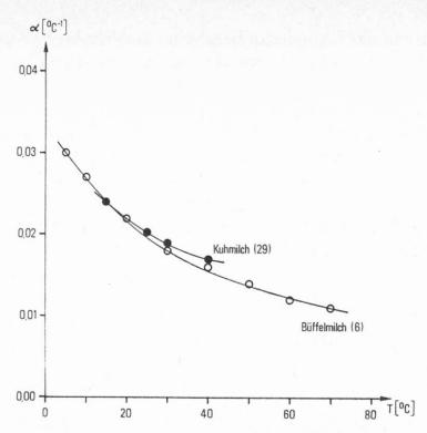
Abb. 3. Temperaturabhängigkeit des linearen Temperaturkoeffizienten (α) der elektrischen Leitfähigkeit von Kuh- und Büffelmilch (nach Sharma (6); siehe Formel (III))
