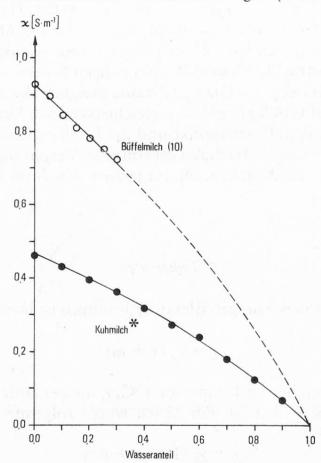
Abb. 1. Einfluß des Wasserzusatzes auf die elektrische Leitfähigkeit (χ) einer Kuh- und einer Büffelmilch (0,0 Wasseranteil entspricht unverdünnter Milch)
