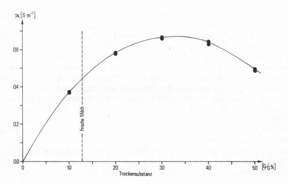
Abb. 4. Beziehung zwischen elektrischer Leitfähigkeit (χ) und Prozentgehalt an Trockensubstanz (TS) einer rekonstituierten Kuhmilch (Eigene Werte, ermittelt durch Auflösen von Vollmilchpulver bei 60 °C in destilliertem Wasser. Meßtemperatur: 20 °C)
