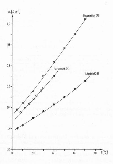
Abb. 2. Temperaturabhängigkeit der elektrischen Leitfähigkeit ( $\chi$ ) von Milch verschiedener Spezies
