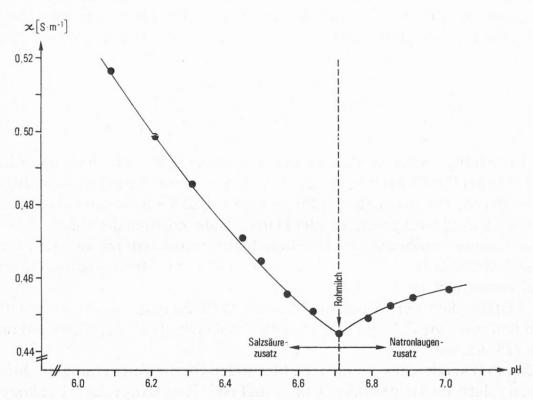
Abb. 5. Abhängigkeit der elektrischen Leitfähigkeit (χ) einer Kuhmilch vom Säure- und Laugezusatz
