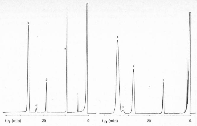
Abb. 3. Gaschromatogramm von den Acetylderivaten der Zuckeralkohole aus Kaugummi Muster B auf einer gepackten Silar 10 C-Säule
