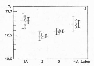
Abb. 2. Wasserbestimmung nach KF. Maisstärke: Titration heiß Zeichenerklärung siebe Abb. 1
