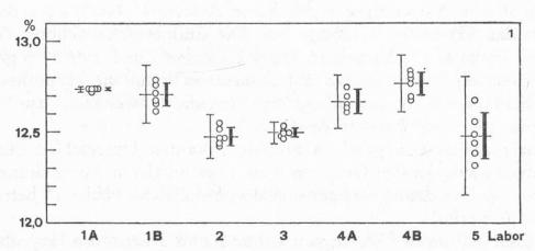
Abb. 1. Wasserbestimmung nach KF. Maisstärke: Titration kalt Zeichenerklärung. O = Einzelwerte; waagrechte Linien = Mittelwerte; dünne senkrechte Linien = Streubereich; fette, senkrechte Linien = Vertrauensbereich des Mittelwertes
