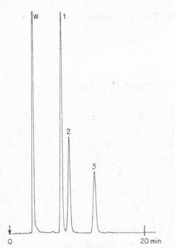
Abb. 1. HPLC-Trennung der Zucker eines Apfelsaftes
