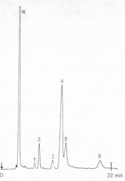
Abb. 3. Trennung der Zucker einer Nährmittelprobe bei 40°C
