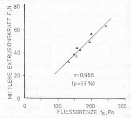
Abb. 8. Korrelation zwischen mittlerer Extrusionskraft und der Casson-Fließgrenze
