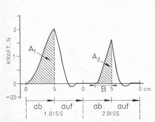
Abb. 3. Typische Instron Kraft-Weg-Kurve zur Bestimmung der Kohäsivität und elastischen Erholung von Instant-Kartoffelpüree
