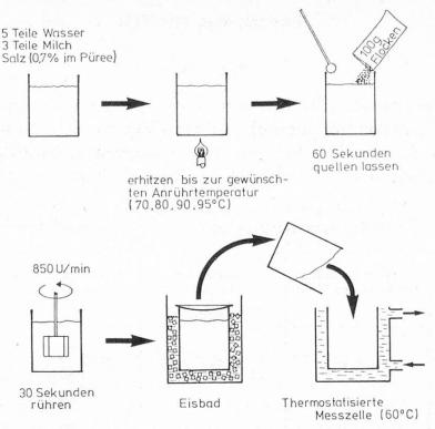
Abb. 1. Rekonstitutionsmethode für die Kartoffeltrockenprodukte
