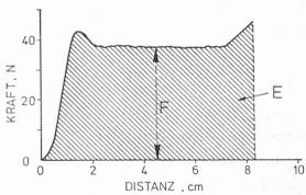
Abb. 2. Kraft-Weg-Kurve eines Rückextrusionstestes mit rekonstituierten Kartoffelflocken
