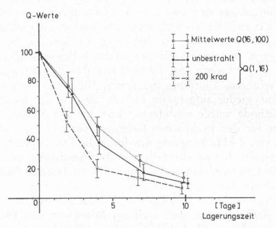
Abb. 1. Verlauf der normierten Q-Werte für Zuchtforellen Q(16,100) ist der aus Messungen bei 16 und 100 kHz bestimmte Wert zum Nachweis der tatsächlichen Lagerungsdauer; Q(1,6) ist der bei 1 und 16 kHz bestimmte Wert zum Nachweis der Bestrahlung. (Der Bereich der Standardabweichung aus 5 Messungen ist gegeben.)
