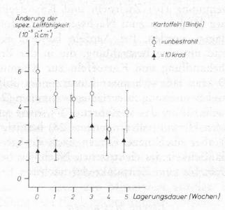
Abb. 3. Verlauf der Aenderungen der spezifischen Leitfähigkeit bei 50 Hz während der Lagerung von Kartoffeln. (Der Bereich der Standardabweichungen aus 5 Messungen ist angegeben.)
