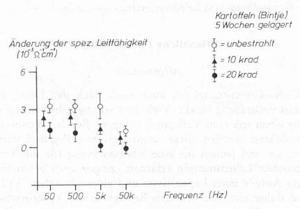
Abb. 2. Aenderungen der spezifischen Leitfähigkeit während 180 s nach dem Einstich der Elektroden in die Kartoffeln in Abhängigkeit von der Meßfrequenz. (Die Standardabweichung aus 5 Messungen ist angegeben.)
