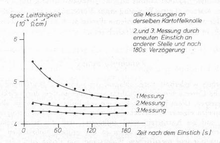
Abb. 4. Verlauf der spezifischen Leitfähigkeit nach dem Einstich der Elektroden in eine Kartoffel und Ablauf der Veränderung ohne Anwesenheit der Elektroden.
