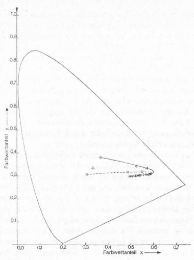
Abb. 2. Farborte bei der Reflexionsmessung an Konfitüre mit verschiedener Schichtdicke
