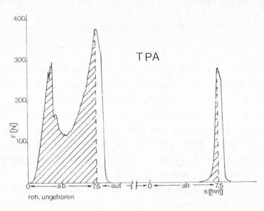
Abb. 7. Kraft-Weg-Kurve bei der Textur-Profil-Analyse einer rohen Möhre (7)
