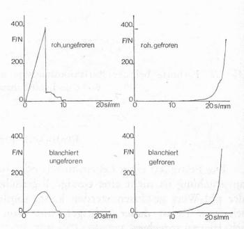
Abb. 5. Kraft-Weg-Kurven bei der Messung der Druckfestigkeit unterschiedlich behandelter Möhren (7)
