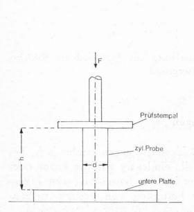
Abb. 4. Aufbau zur Bestimmung der Druckfestigkeit
