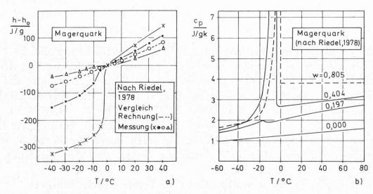
Abb. 10. a) Enthalpiedifferenz h— $h_0$  ( $h_0 = 0$  bei T = 0°C) von Magerquark in Abhängigkeit von der Temperatur T. Vergleich zwischen Messung und Berechnung nach einer empirischen Formel nach Riedel (68)
