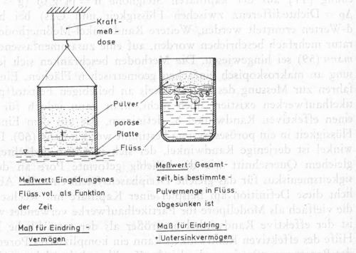
Abb. 8. Meßmethoden zur Bestimmung des Eindringvermögens von Flüssigkeiten und des Untersinkvermögens von Partikeln bei Instantprodukten
