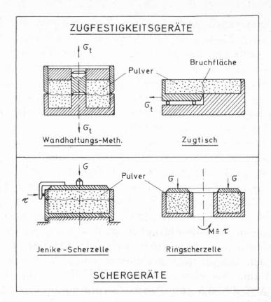
Abb. 6. Schematische Darstellung von Geräten zur Messung der Zugfestigkeit und des Scherverhaltens von dispersen (pulverförmigen) Stoffen
