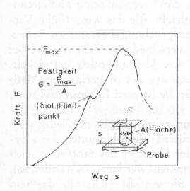
Abb. 3. Typischer Kraft-Weg-Verlauf eines Druckversuches, bei dem eine Maximalkraft F<sub>max</sub> auftritt
