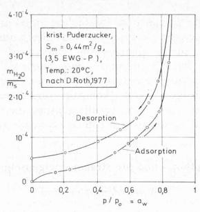
Abb. 11. Beispiel für eine Sorptionsisotherme aus Messungen von Roth (74) bei T = 20°C an kristallinem Puderzucker
