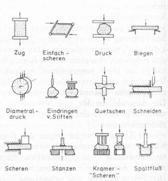
Abb. 4. Schematische Darstellung einiger mechanischer Beanspruchungsarten, die als Prüfmethoden für Lebensmittel gebräuchlich sind
