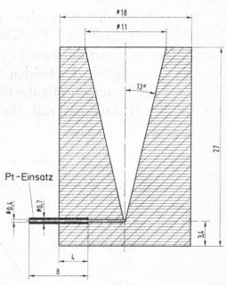
Abb. 2. Teflon-Einspritzgefäß Schnitt (Maße in mm)
